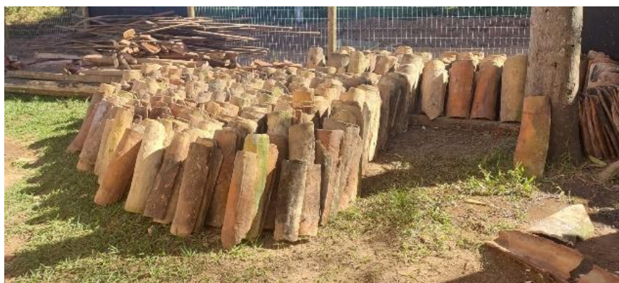
Caeias e telhas prospectadas e triadas para reuso
